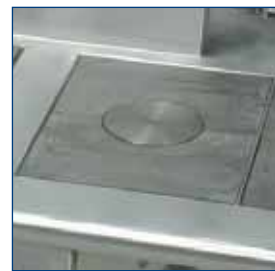
Plaque coup de feu fonte de forte épaisseur montée au-dessus d'une cuvette inox étanche (brûleur, tampon et cuvette avec béton réfractaire démontables) Allumage électrique et sécurité par thermocouple
