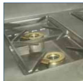
Feux nus avec brûleurs corps inox démontables montés dans une cuvette étanche à niveau constant avec grilles inox (allumage électrique et sécurité par thermocouple)
